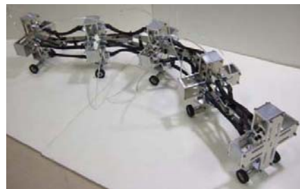
Fig. 5. 空気圧アクチュエータを用いたヘビ型ロボット
