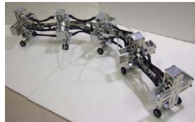
図7: 空気圧アクチュエータを用いたヘビ型ロボット
