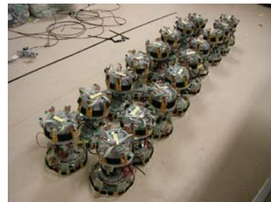
図9 アメーバ型ロボット Slimebot
