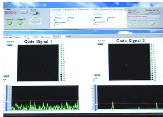
図4：RASICAによるBMIシステムのコンピュータ画面。上は12本の電極上のスパイクとICAで分離された個々のニューロンのスパイク波形を表示しており、下は分離された16個のニューロンによる発火頻度の加算値（画面左下）と同期発火の検出（画面右下）を表示している。
