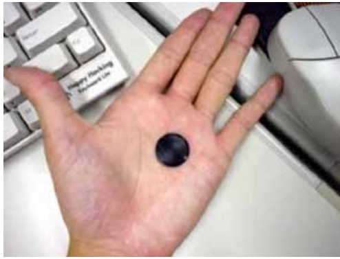
図 2: An RFID tag. The tag holds 128k bytes data.
