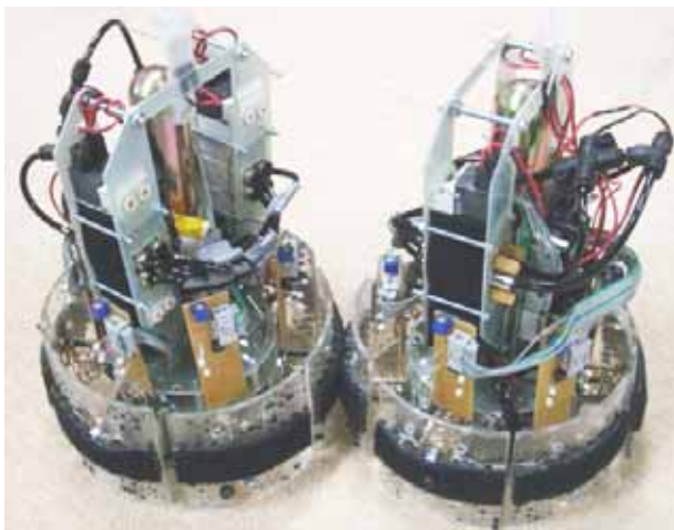
図 B2 製作したモジュールの試作機.
